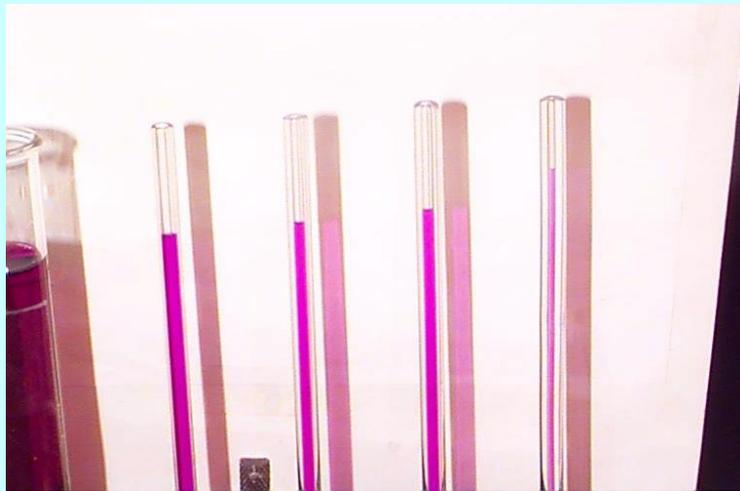
In questi tubi di diametro diverso si ha risalita capillare, segnalata dal colore del fluido, in funzione del diametro.
