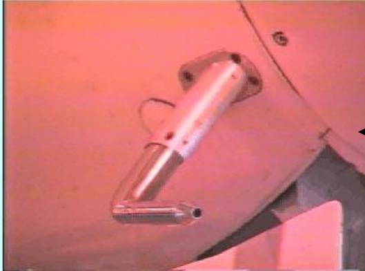
Il tubo di Pitot viene sovente applicato nell'industria aeronautica per la misura della velocità degli aeromobili (misurando la differenza di velocità fra l'atmosfera e l'aeromobile) e per la misura della velocità nelle tubazioni. Nota che l'apparecchio fornisce una misura puntuale.
