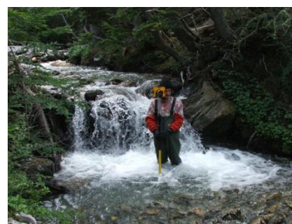
Fig. 17 – Rilevamento del profilo longitudinale di un torrente montano, con misura della pozza a valle di uno step-pool .
