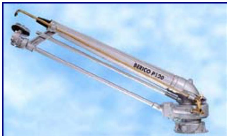
Irrigatore a lunga gittata e grande portata, adatto per impianti d'irrigazione a pioggia ad alte pressioni, funzionamento meccanico, rotazione a giro completo e settori regolabili.
