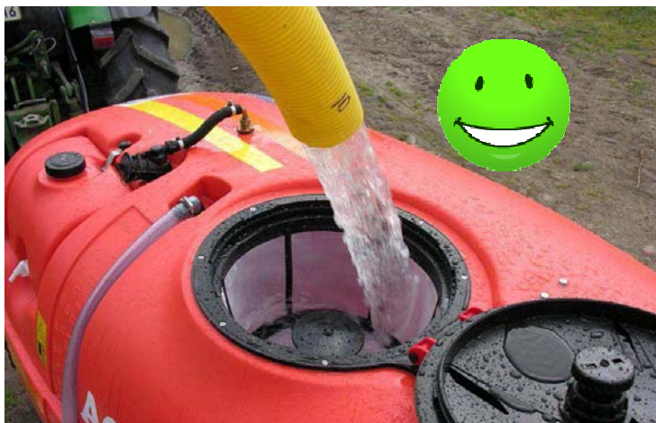
Fig. 58 – Corretto riempimento del serbatoio dell'irroratrice (foto ISK).
