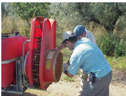
Fig. 149 – Regolazione dell'inclinazione delle pale.
