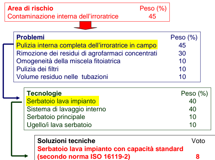
Fig. 172 - Esempio di calcolo del contributo al punteggio EOS determinato dalla scelta di una specifica soluzione tecnica relativa al serbatoio lava impianto di una barra irroratrice.
