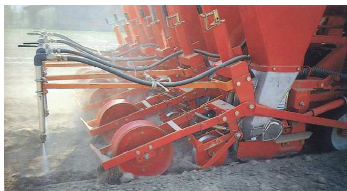
Fig. 159 – Irroratrice per diserbo localizzato abbinata a seminatrice.
