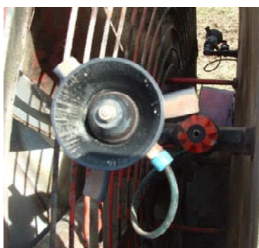
Fig. 191 - Esempio di ugello rotativo per atomizzatori
