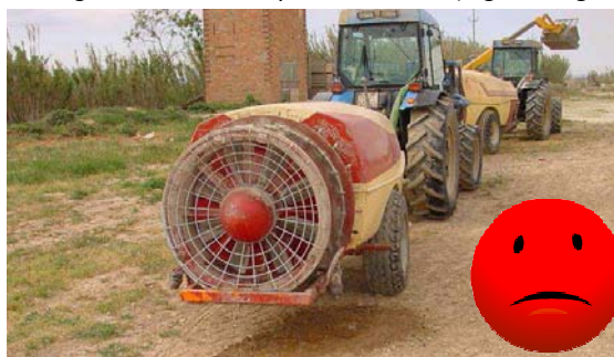
Fig. 7 – Assicurarsi che non ci siano perdite di prodotto dall'irroratrice durante il trasferimento in campo (foto CMA).
