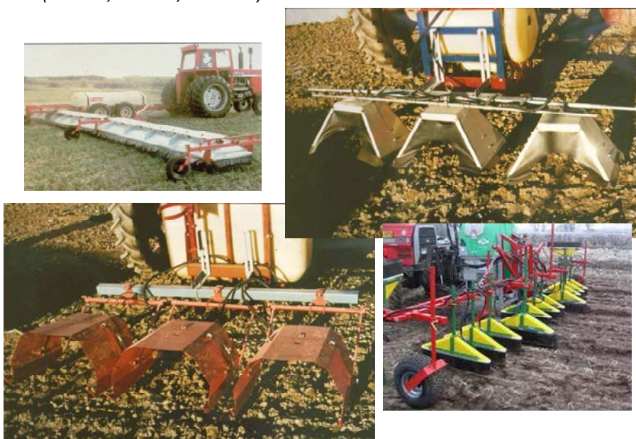
Fig. 123 – Esempi di schermature su barre irroratrici.
