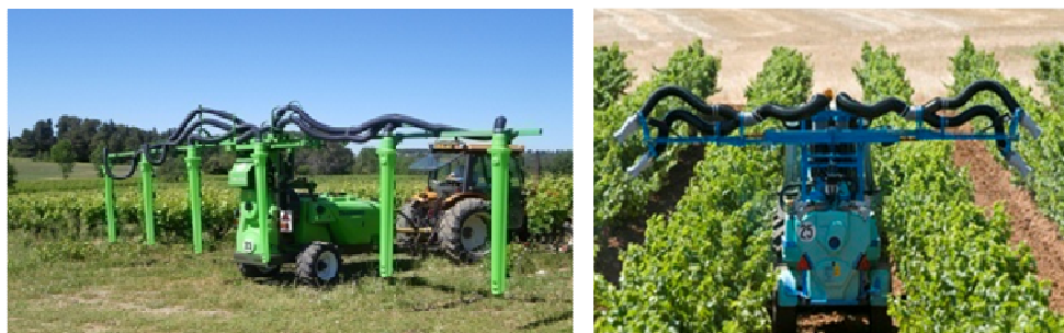
Fig. 184 - Irroratrice scavallante: A) con ugelli a polverizzazione idraulica; B) con diffusori pneumatici.
