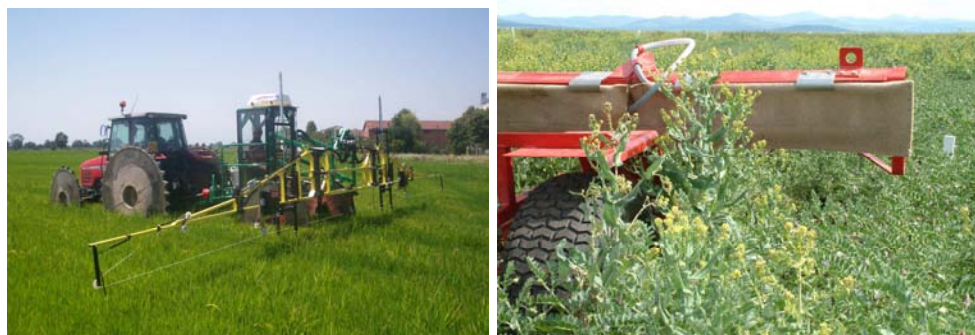
Fig. 163 – Esempi di differenti tipologie di barra umettante
