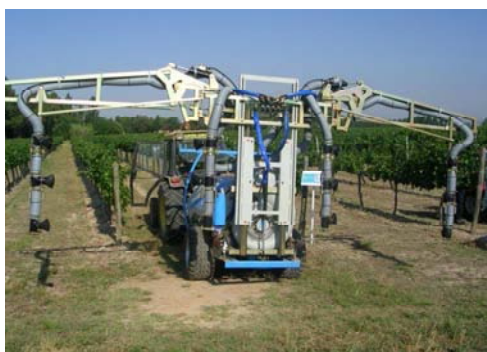
Fig. 165 – Irroratrice scavallante che tratta due filari completi per volta.
