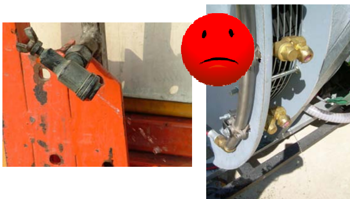
Fig. 34 - Esempio di ugello NON dotato di dispositivi antigoccia (sinistra) e di antigoccia non funzionante (destra).
