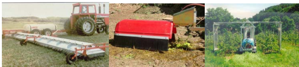
Fig. 185 - Esempi di irroratrici schermate
