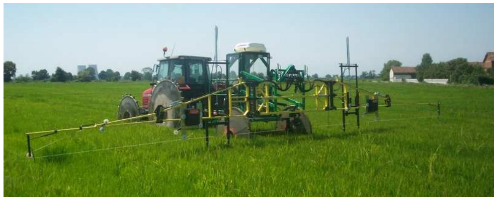
Fig. 124 – Impiego di barra umettante contro il riso crodo (foto: MAR sas - Ronsecco – VC).
