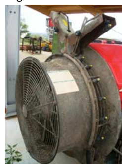
Fig. 180 – Deflettori dell'aria su ventilatore assiale.
