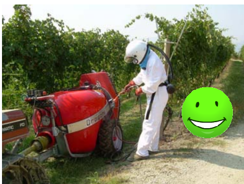
Fig. 82 – Lavaggio esterno della macchina irroratrice in campo al termine del trattamento utilizzando una lancia e l’acqua del serbatoio lavapianto.
