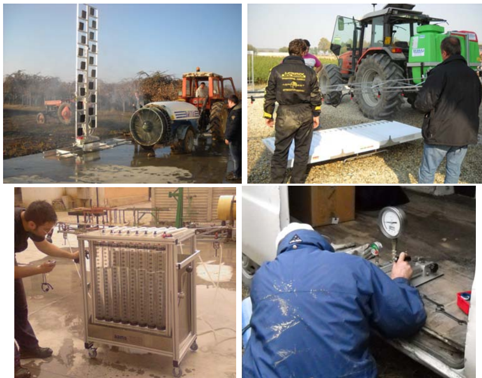
Fig. 125 – Esempi di alcune fasi di esecuzione del controllo funzionale su macchine irroratrici in uso.
