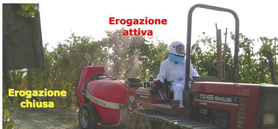
Fig. 137 – Interruzione dell'erogazione sul lato esterno dell'ultimo filare dell'appezzamento.
