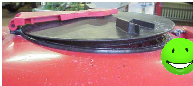
Fig. 41 – Esempio di coperchio del serbatoio principale della macchina irroratrice con adeguato sistema di chiusura.
