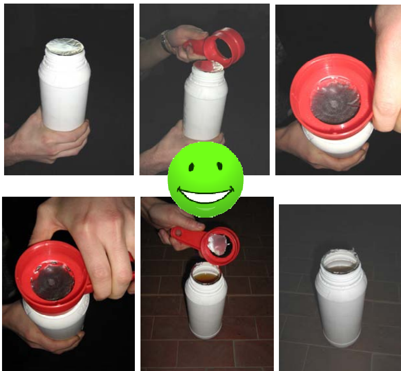
Fig. 60 – Rimozione in sicurezza della linguetta di protezione dei flaconi di fitofarmaci con l'impiego di un apposito taglierino (cutter).
