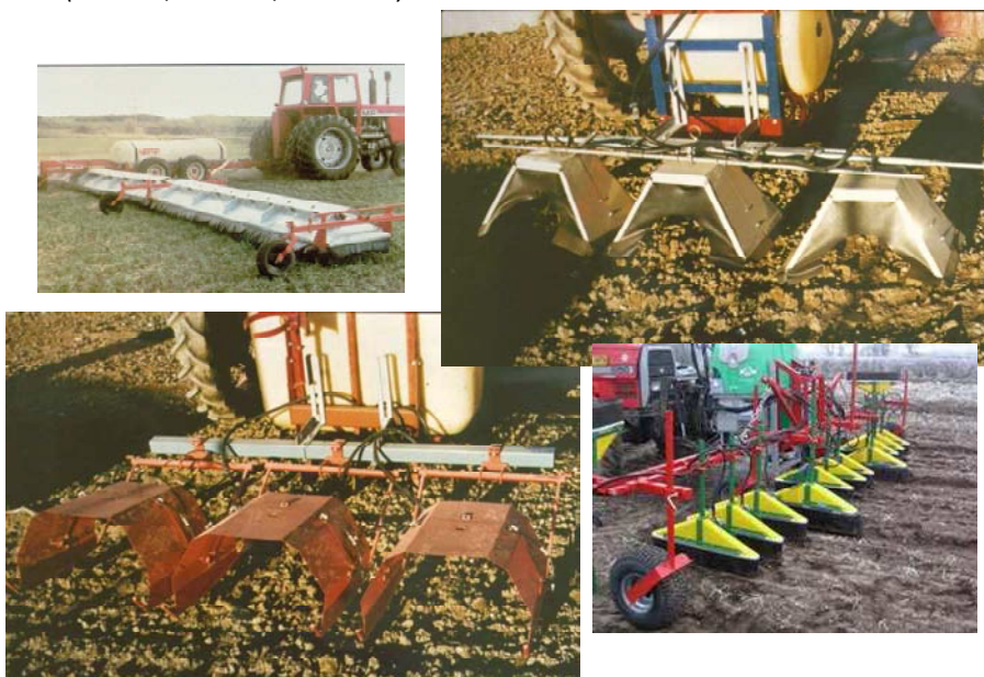
Fig. 123 – Esempi di schermature su barre irroratrici.
