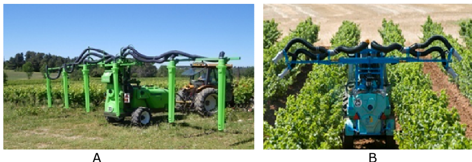
Fig. 184 - Irroratrice scavallante: A) con ugelli a polverizzazione idraulica; B) con diffusori pneumatici.
