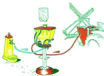
Fig. 63 - Preparazione della miscela fitoiatrica in modo non sicuro (Foto UPC).
