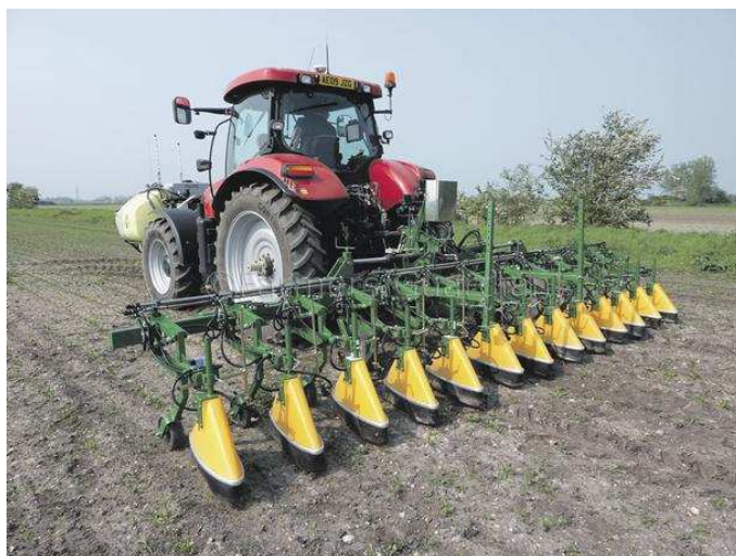
Fig. 160 – Diserbo schermato sulla fila. (foto: www.farmersguardian.com ).
