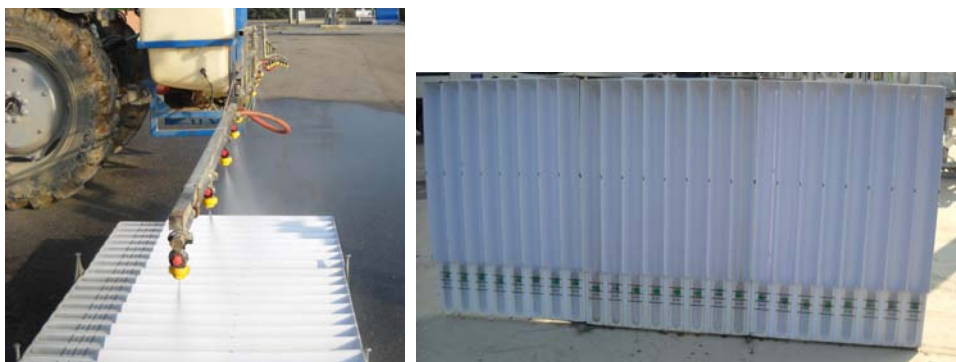
Fig. 181 - Attrezzatura utilizzata per misurare la qualità della distribuzione trasversale.
