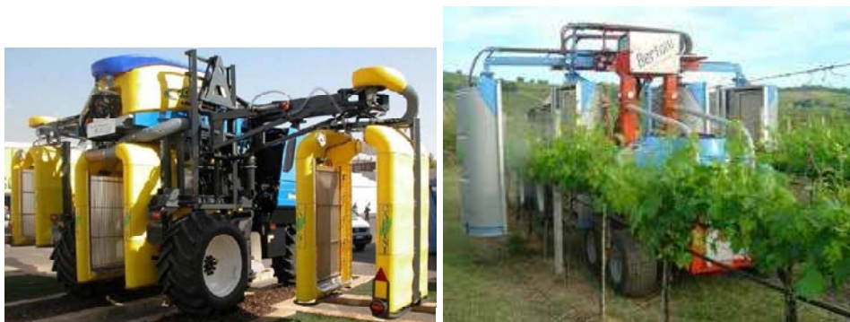
Fig. 164 - Esempi di irroratrici con sistema di recupero del liquido che oltrepassa il filare.
