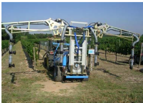
Fig. 165 – Irroratrice scavallante che tratta due filari completi per volta.
