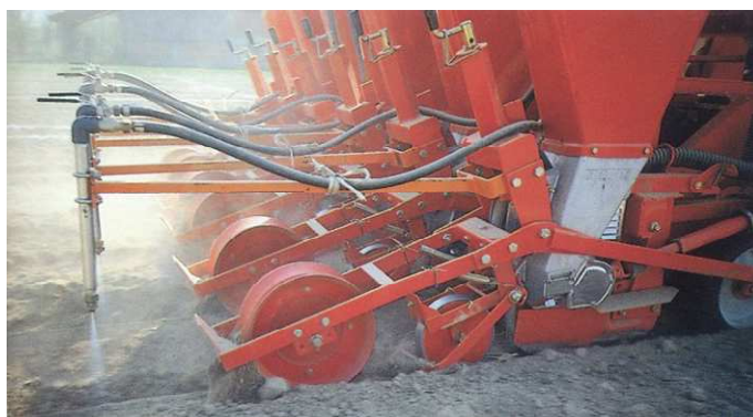
Fig. 159 – Irroratrice per diserbo localizzato abbinata a seminatrice.
