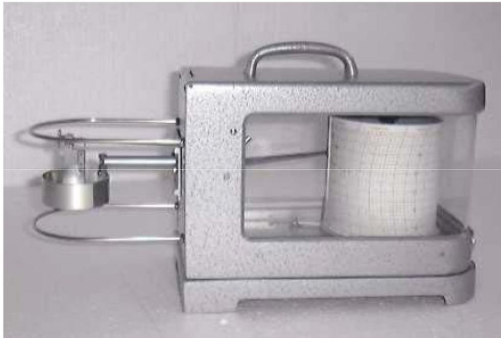
**Termografo a lamina ad anello (produzione SIAP)**
