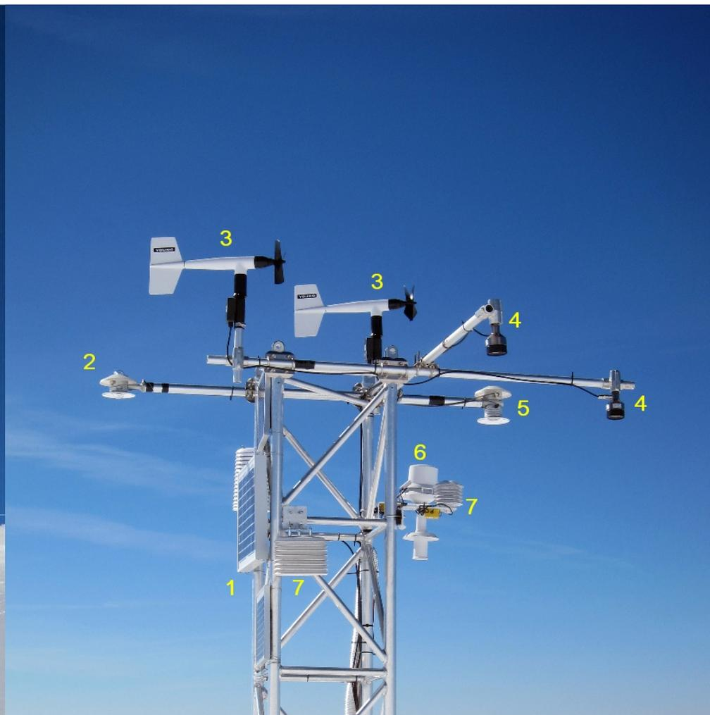
Stazione meteorologica automatica installata sull'Ortles a 3850 m di quota. Descrizione dei sensori: **1** = pannelli solari; **2** = radiazione solare incidente e riflessa (albedometro); **3** = velocità e direzione vento; **4** = altezza neve; **5** = radiazione infrarossa in entrata e in uscita; **6** = temperatura e umidità (schermo ventilato); **7** = temperatura (schermo a ventilazione naturale).
