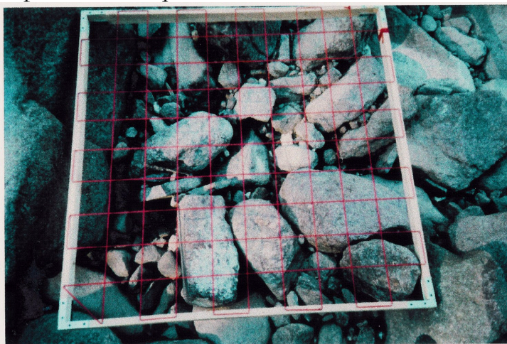
Figura 1 – Il letto di un torrente montano: le dimensioni dei sedimenti superano non di rado le decine di centimetri. La griglia sovrapposta misura 10 cm di lato (in questo caso è opportuno che il campionamento avvenga prefissando una dimensione della griglia di campionamento pari ad almeno 40 cm). Da notare la grande eterogeneità del materiale; la caratterizzazione granulometrica avviene attraverso la determinazione di diametri caratteristici ottenibili dalla curva granulometrica..
