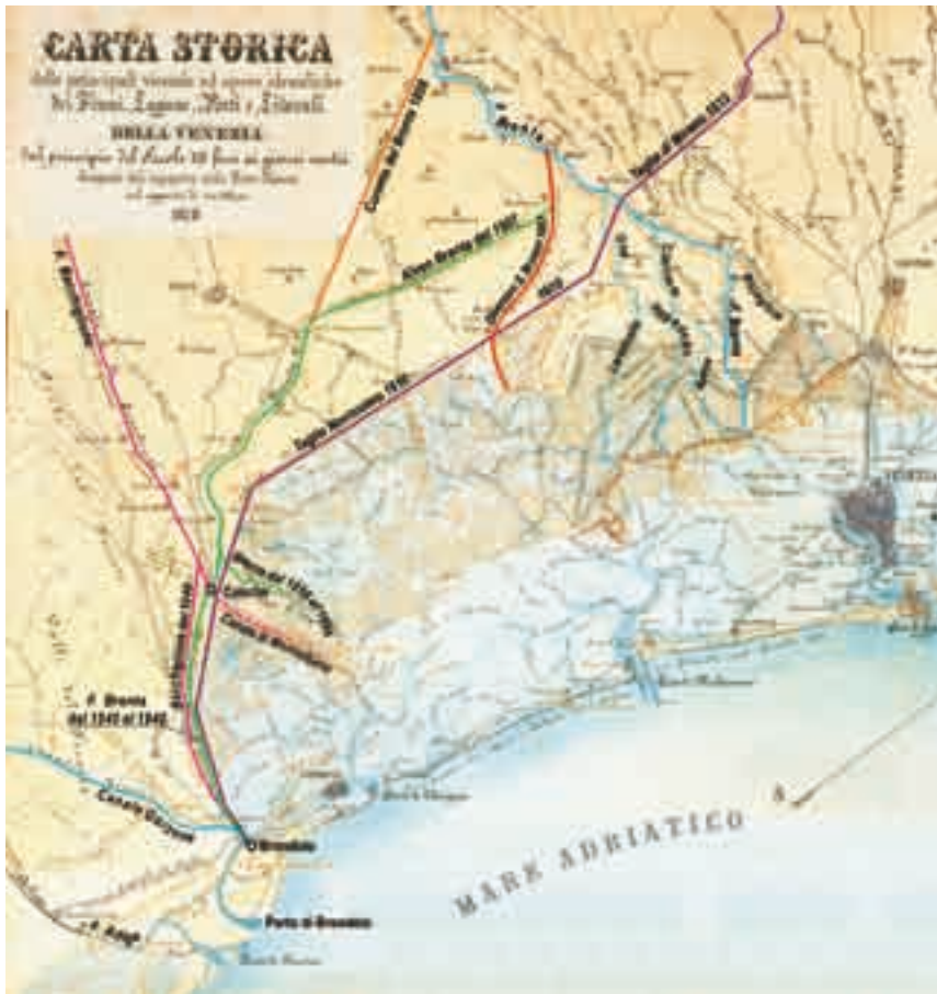
Fig. 3.2 - Le deviazioni e le nuove inalveazioni del Brenta realizzate dopo gli interventi di instadadura attuati nel corso del XIV secolo per difendere la laguna dagli interrimenti, riportate nella carta di Pietro Marcon (1878).
