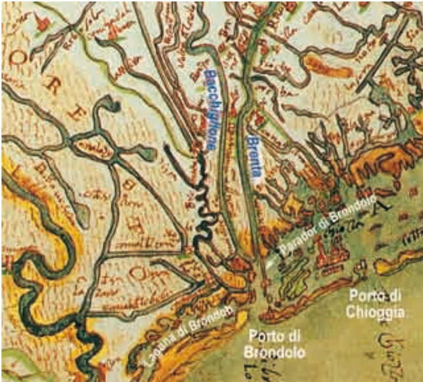
Fig. 3.3 - Particolare, tratto da una mappa di Cristoforo Sabbadino del 1557 (vedi Fig. 3.4), del tracciato terminale del Brenta e del Bacchiglione portati a sfociare nella laguna di Brondolo. Accanto alle foci dei due fiumi è evidenziata la posizione del «parador» realizzato a difesa della laguna di Chioggia. BNMVE, mss. it IV, 485 (= 5350) (con interventi dell'autore).
