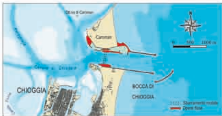
Fig. 6.3 - Bocca di Chioggia. Le opere previste dal progetto definitivo approvato per la difesa dalle «acque alte» con ubicazione del molo esterno e del porto rifugio in adiacenza al litorale di Caroman.
