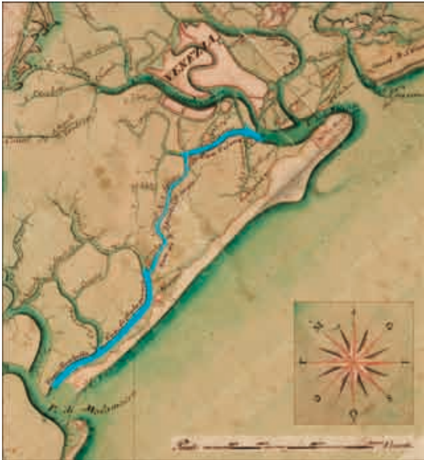
Fig. 5.1 - Il tracciato del canale navigabile di S. Spirito, realizzato nel 1726 per collegare il porto di Malamocco a Venezia, evidenziato sulla carta di Angelo Emo (1763). ASVE, S.E.A., disegni, Laguna, n. 167 (con interventi dell'autore).
