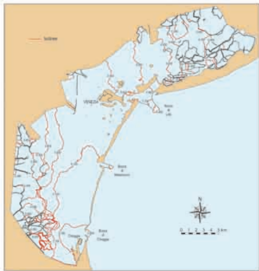
Fig. 7.24 - Laguna del 1901. Inviluppo dei livelli massimi per la marea di riferimento considerata.
