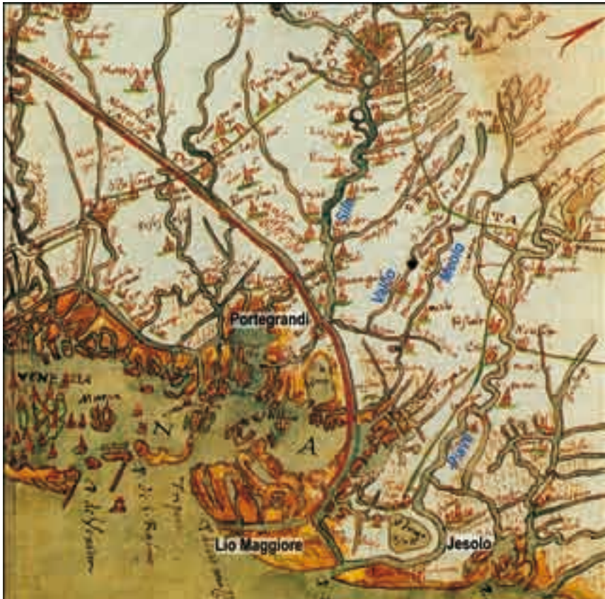
Fig. 3.8 - Particolare della laguna superiore tratto dalla carta di Fig. 3.4. Ben evidenziato il taglio ipotizzato da Cristoforo Sabbadino per il recapito delle acque dolci del Sile e di altri corsi di risorgiva nella foce di Lio Maggiore (Lio Mazor). BNMVE, mss. it, 485 (= 5350) (con interventi dell'autore).
