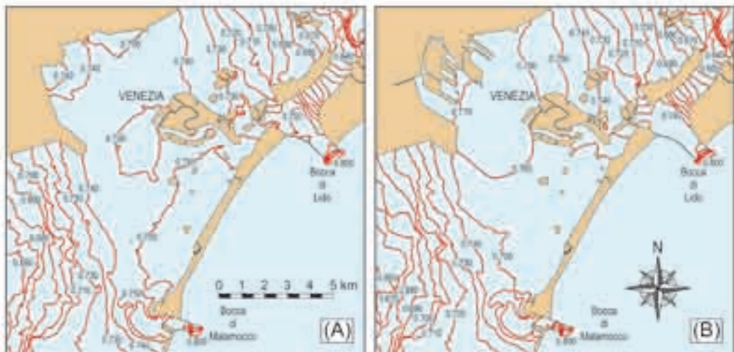
Fig. 7.28 - Involuppo dei livelli massimi nella parte di bacino lagunare più direttamente interessata dalla presenza del canale navigabile Vittorio Emanuele prima (A) e dopo (B) la sua costruzione per la marea di riferimento considerata.
