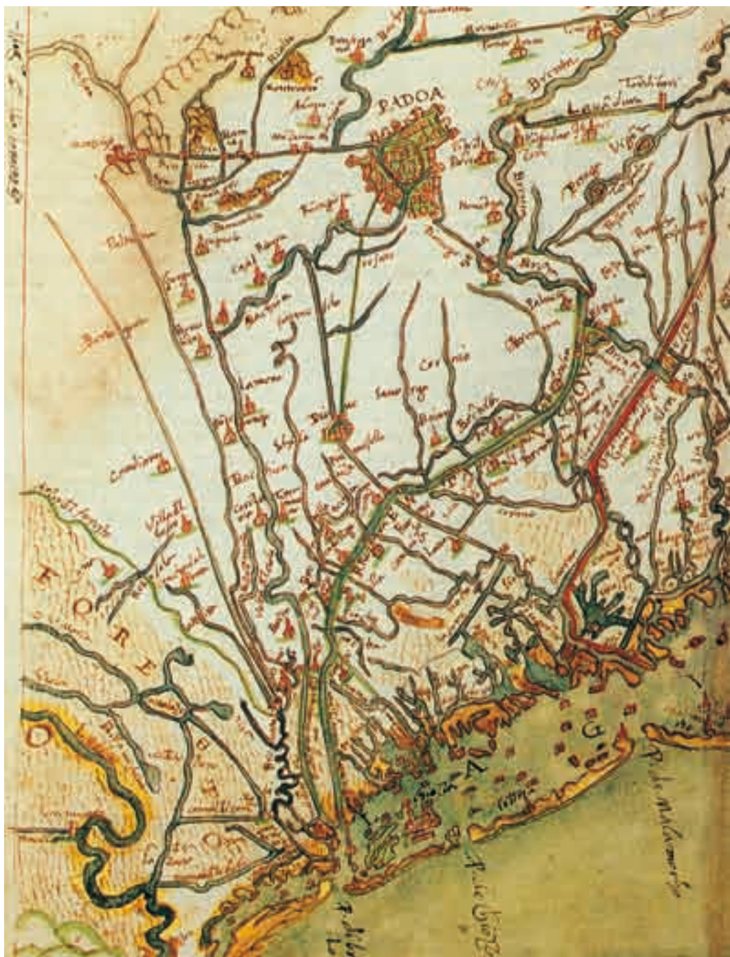
Fig. 3.4. - La laguna di Venezia secondo una mappa di Cristoforo Sabbadino del 1557. Si notano la nuova inalveazione del Brenta e del Bacchiglione con le foci portate nella laguna di Brondolo e, a ridosso delle linee in rosso, i due tagli proposti per allontanare da Venezia e dalla laguna superiore le acque dolci del bacino scolante. BNMVE, mss. it IV, 485 (= 5350).
