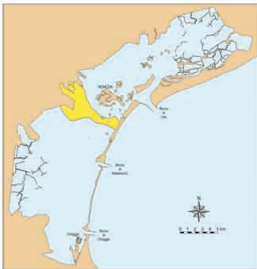
Fig. 7.34 - Linee di spostamento estremo del partiacque tra i bacini di Malamocco e di Lido a seguito della costruzione del canale navigabile Malamocco-Marghera per la marea di riferimento considerata.
