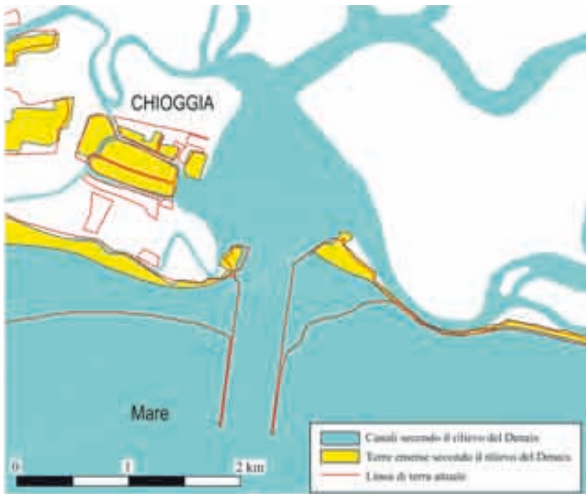
Fig. 7.19 - Confronto tra la configurazione planimetrica della bocca di Chioggia nella condizione attuale e in quella esistente al tempo di Dénaix.
