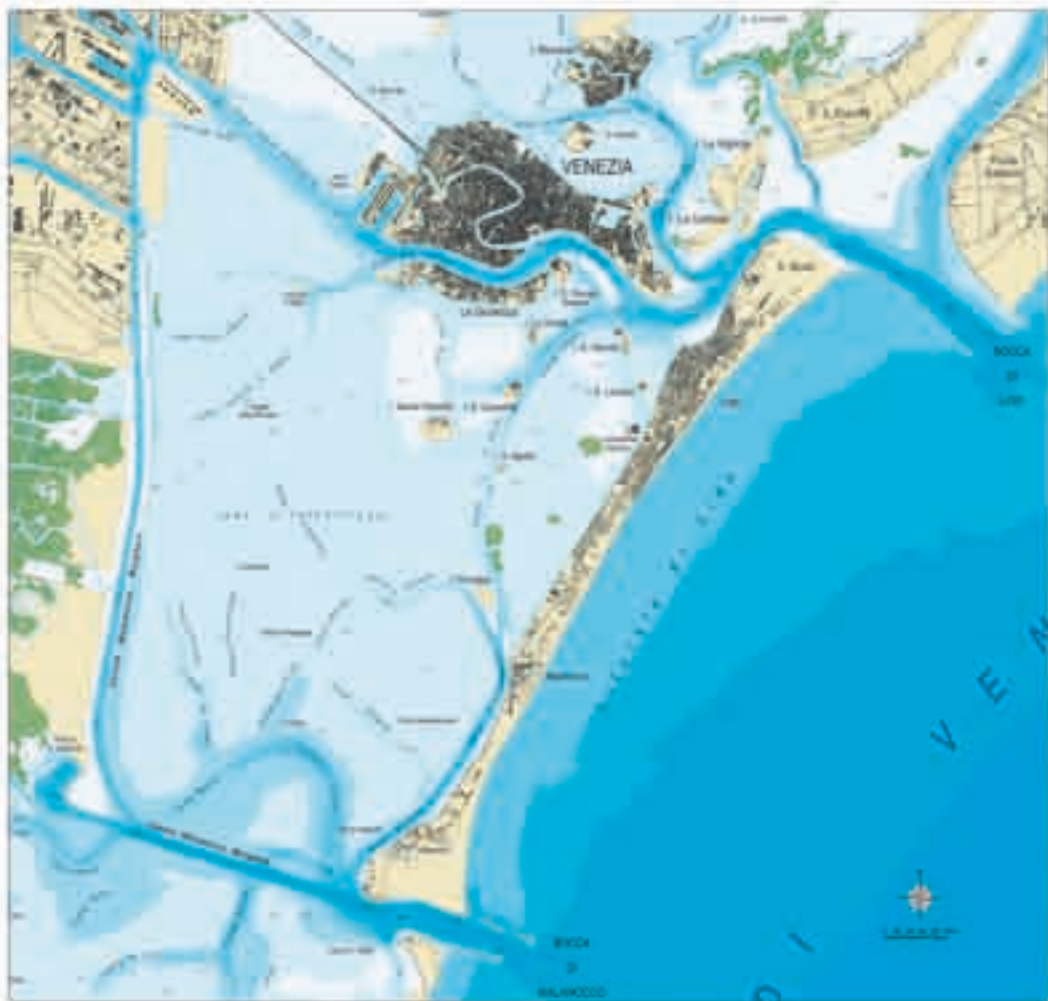
Fig. 5.4 - Il tracciato del canale Malamocco-Marghera costruito tra gli anni 1964 e 1968 per collegare direttamente la bocca di Malamocco con la Zona Industriale di Porto Marghera.
