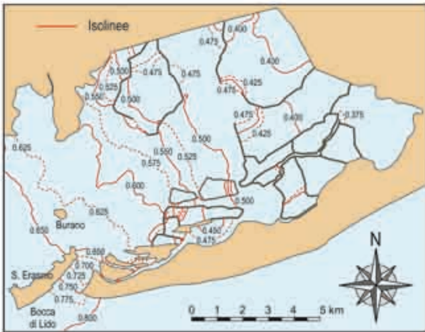
Fig. 8.5 - Inviluppo dei massimi livelli di marea nella laguna superiore nei primi decenni dell'Ottocento per la marea di riferimento considerata.
