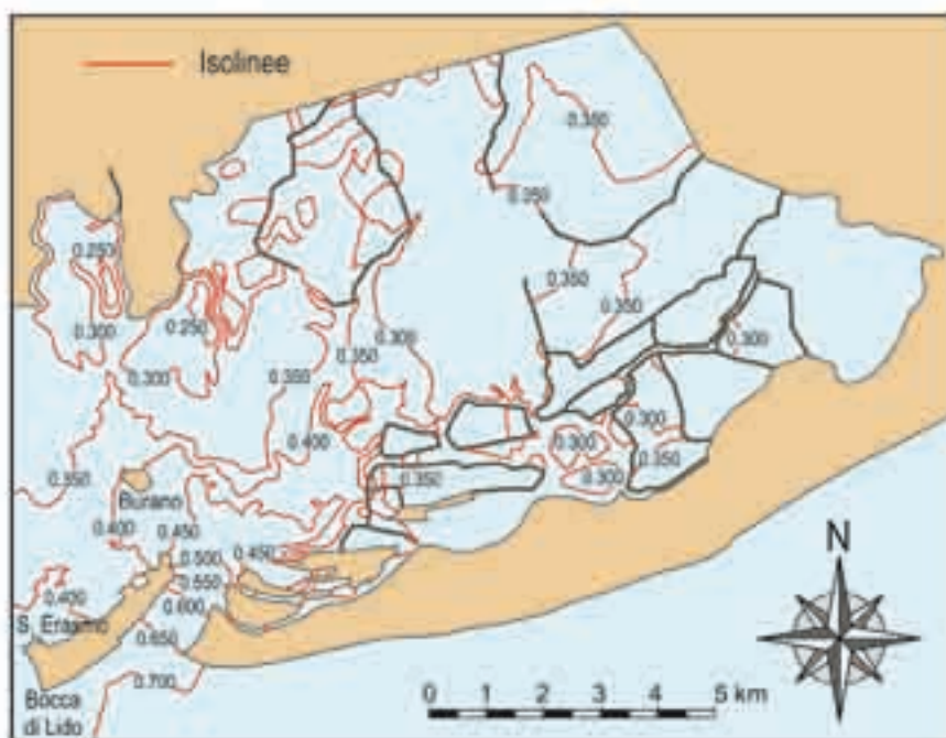
Fig. 8.6 - Gradienti istantanei dei livelli di marea nella laguna superiore nei primi decenni dell'Ottocento per la marea di riferimento considerata.
