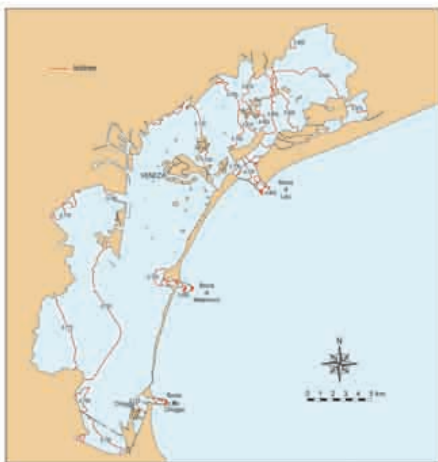
Fig. 9.5 - Involuppo dei livelli massimi in laguna nell'ipotesi di inserire alle bocche le opere fisse previste dal progetto redatto nel 1981 dagli esperti nominati dal Ministero dei Lavori Pubblici, per la marea di riferimento considerata.
