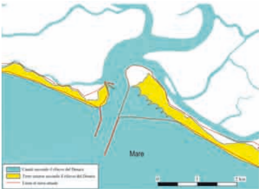
Fig. 7.18 - Confronto tra la configurazione planimetrica della bocca di Malamocco nella condizione attuale e in quella esistente al tempo di Déniax.
