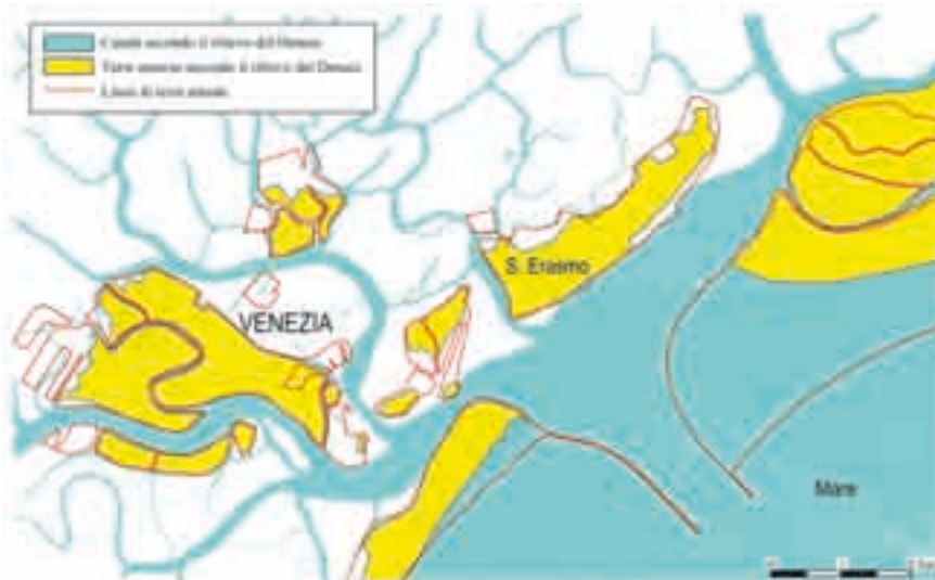
Fig. 7.17 - Confronto tra la configurazione planimetrica della bocca di Lido nella condizione attuale e in quella esistente al tempo di Déniax.
