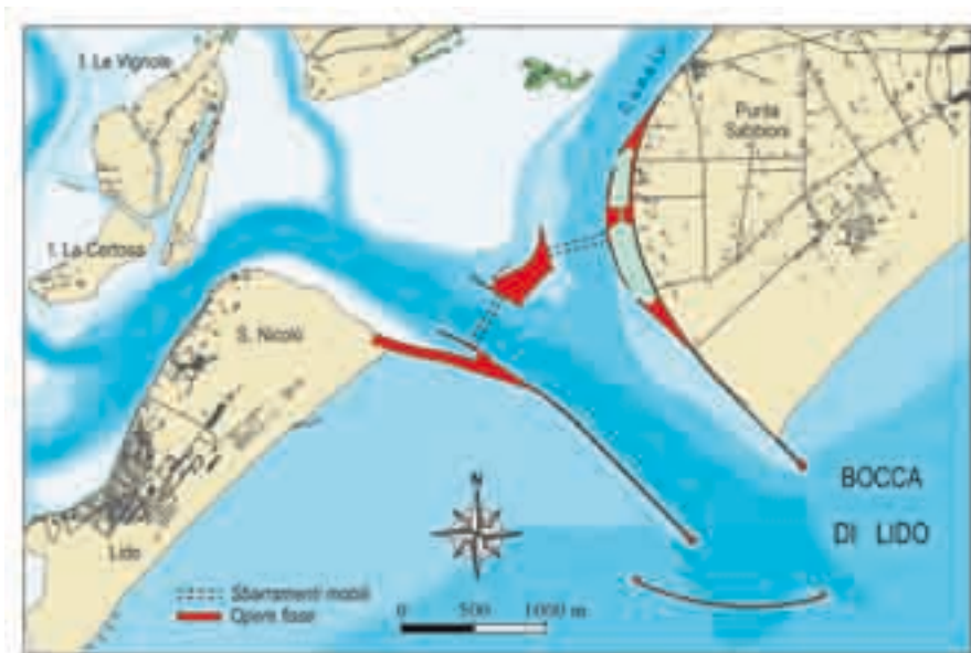
Fig. 6.1 - Bocca di Lido. Le opere previste dal progetto definitivo approvato per la difesa dalle «acque alte». Il molo esterno non è stato al momento ancora realizzato.
