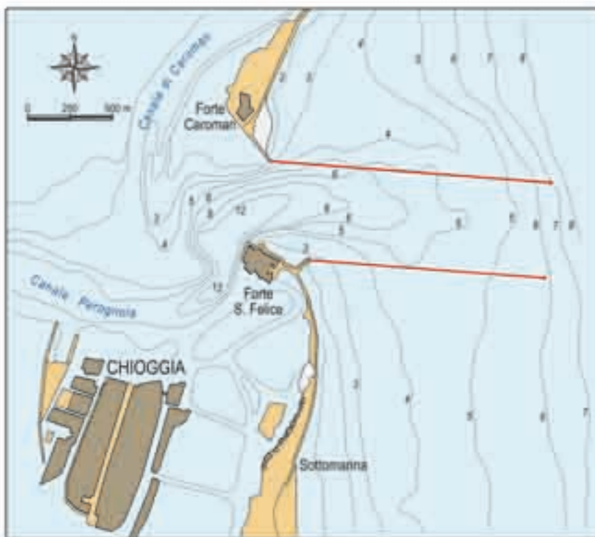
Fig. 4.9 - Il piano di costruzione dei moli alla bocca di Chioggia secondo le variazioni suggerite da Cucchini al progetto Rossi.
