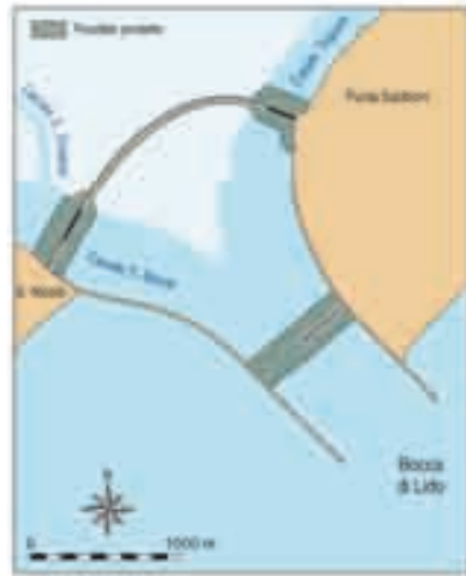
Fig. 9.1 - Le opere fisse previste per la bocca di Lido dal progetto redatto nel 1981 dagli esperti nominati dal Ministero dei Lavori Pubblici (Ghetti e Batisse 1983).
