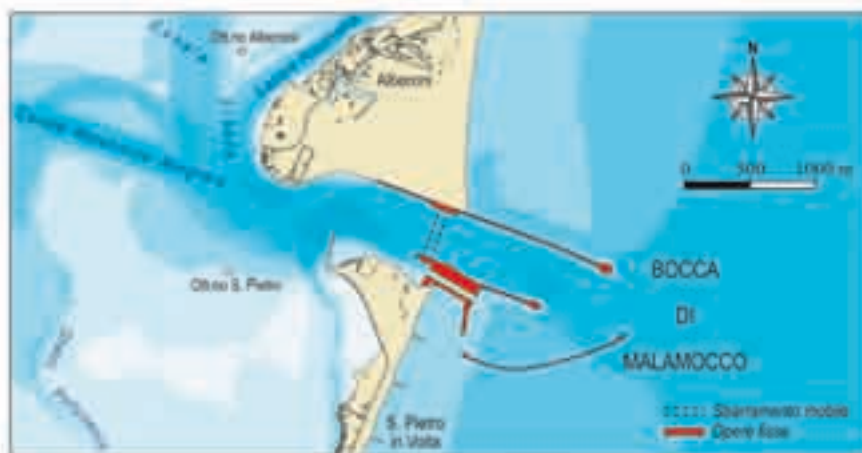
Fig. 6.2 - Bocca di Malamocco. Le opere previste dal progetto definitivo approvato per la difesa dalle «acque alte» con ubicazione della conca di navigazione e del molo esterno.
