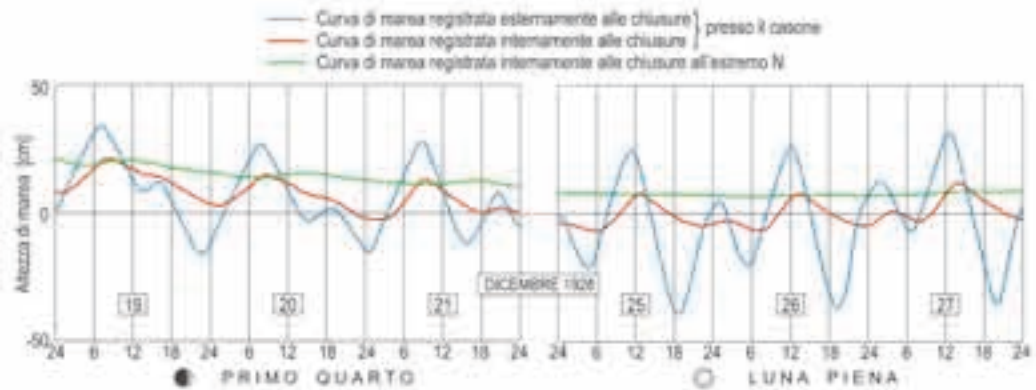
Fig. 8.7 - Dislivelli di marea misurati a Valle Grassabò a cavallo del paré di grissiole che la separava dalla laguna negli anni '20 del secolo passato.
