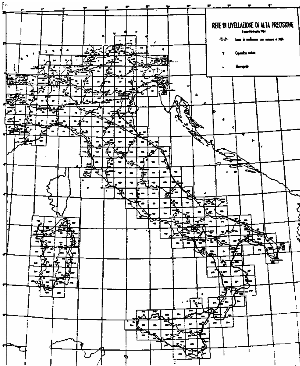
Fig. 4.8 rete di linee di livellazione geometrica di precisione
