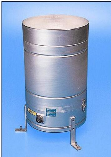
Per la misura dell'afflusso meteorico nel caso di precipitazioni solide, il pluviometro deve essere riscaldato.
